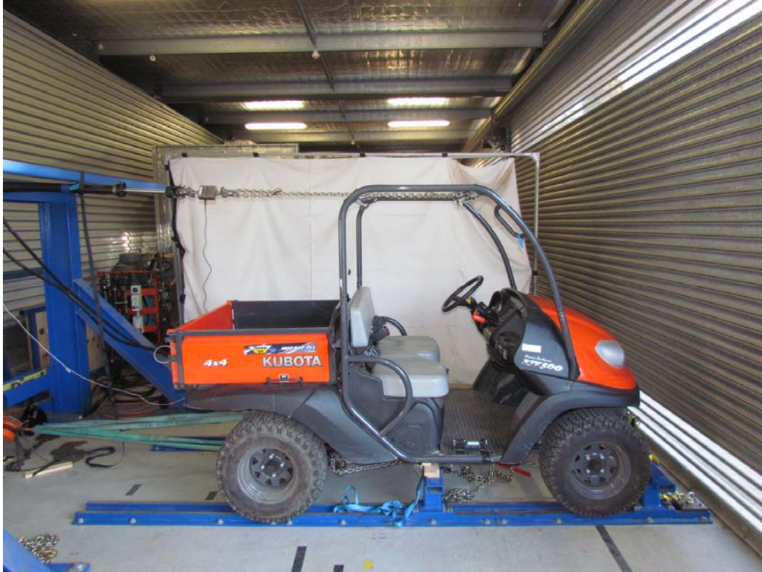
SSV ROPS test – Longitudinal test GI40101
