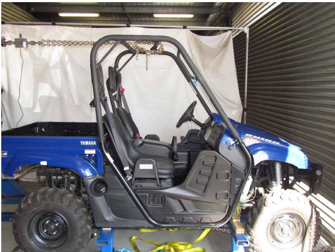
SSV ROPS test – Longitudinal test GI40102
