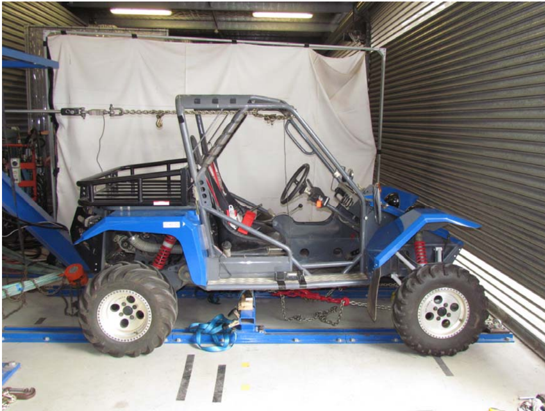
SSV ROPS test – Longitudinal test GI40103
