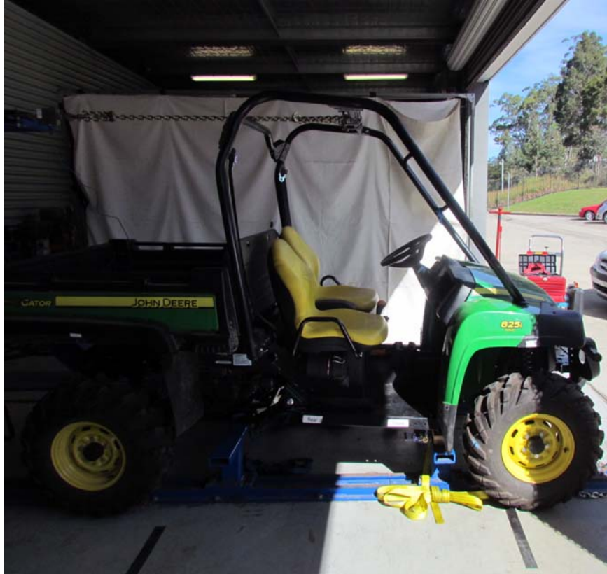
SSV ROPS test – Longitudinal test GI40091
