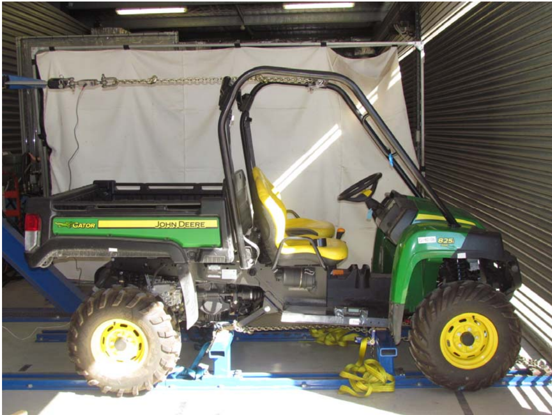
SSV ROPS test – Longitudinal test GI40106
